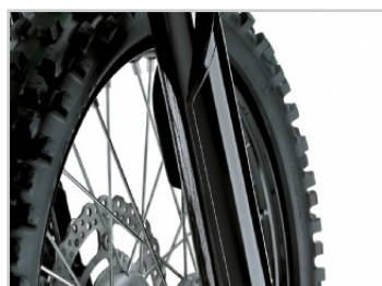
Kayaba AOS Gabel mit neuer DLC-Beschichtung
